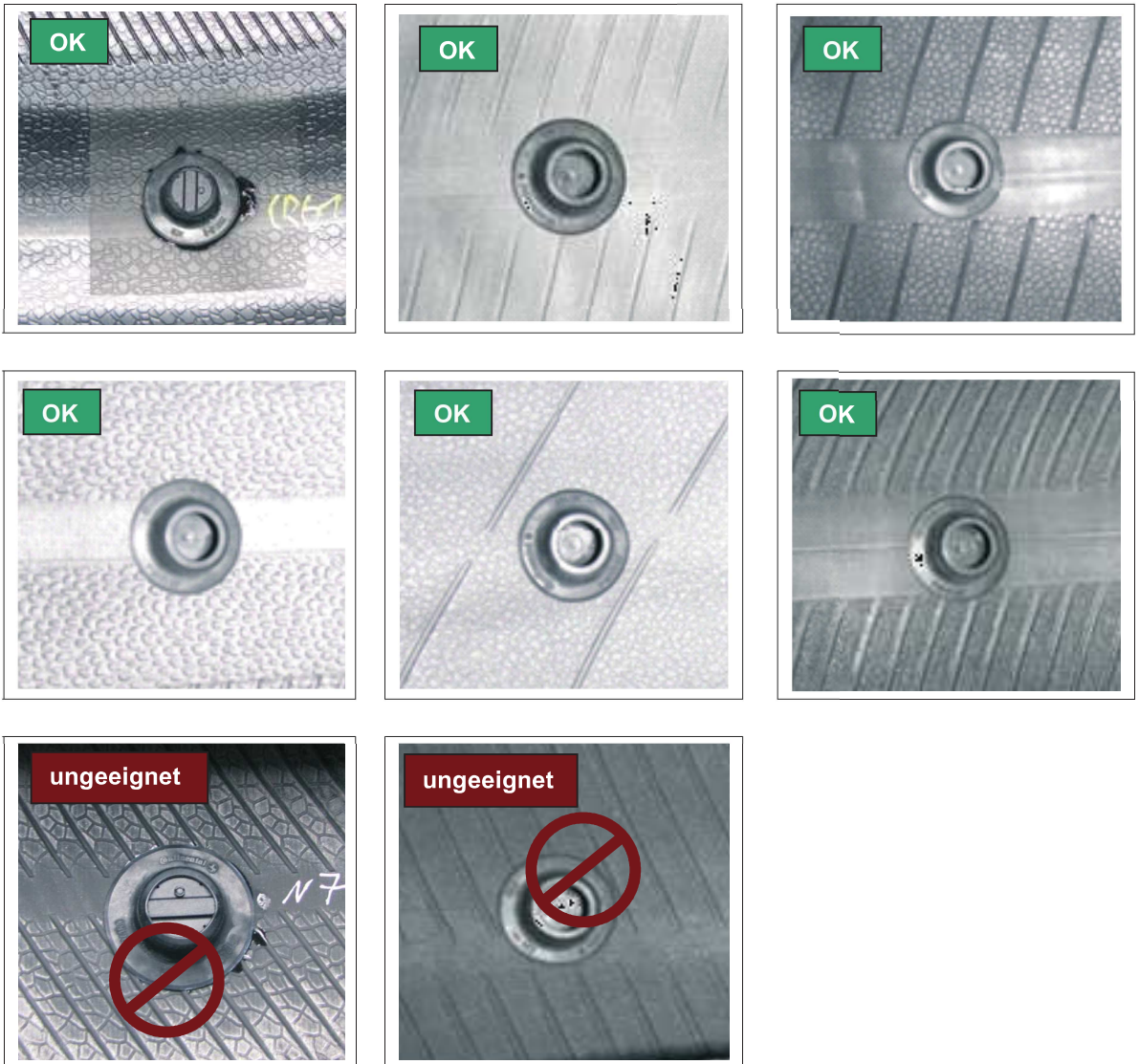
Abbildung 5 Beispiele für die Einklebposition des Containers
